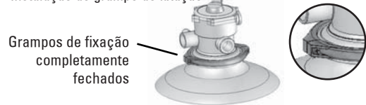
FIGURA 4 - Instalação do grampo de fixação
